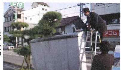
09~13年に市役所前に展示したデザイン検討用の実物大模型で水切りの実験も実施(写真:eau)
