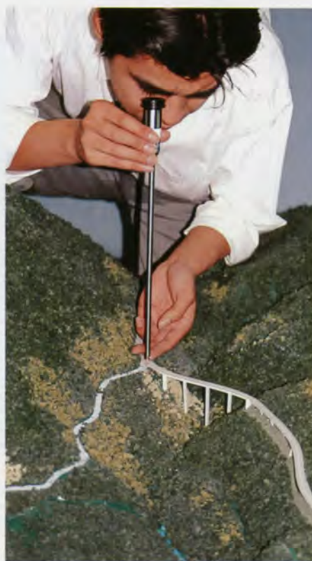
【図2】モデルスコープを用い、山岳道路模型の観察を行っているところ
