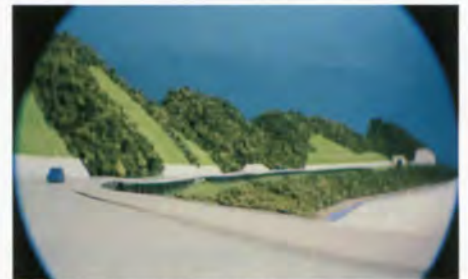
【図6】 縮尺1/300の道路検討模型（モデルスコープ写真）
