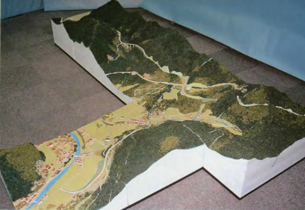
【図1】新設道路の景観検討のための縮尺1/1000模型の事例。課題抽出とゾーン分け、線形変更、橋梁形式の検討に利用
