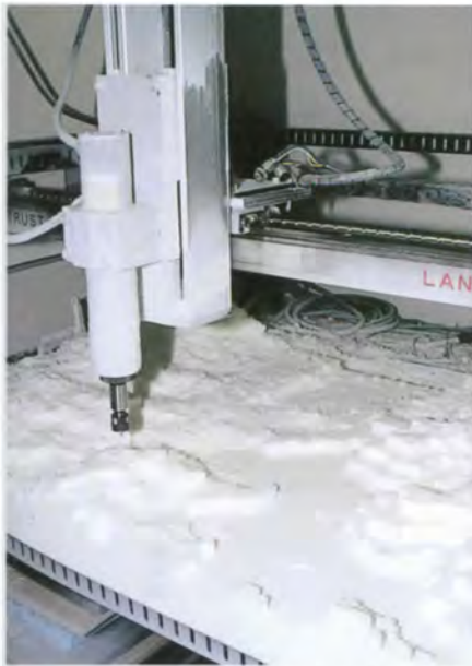
【図3】 切削マシンにより等高線に沿って削り出される地形模型（写真提供：(株)トラストシステム）
