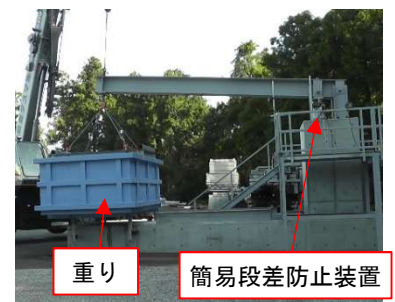
図-4 クリープ試験状況
