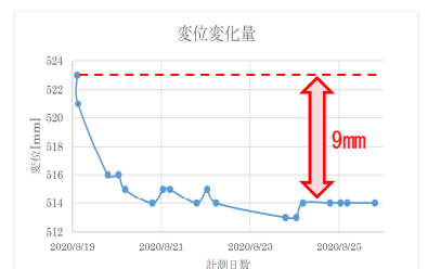
図-5 耐クリープ特性(沈下量)
