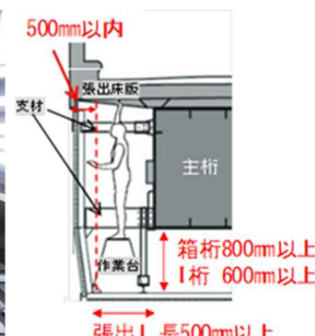
図-1 常設足場形状
